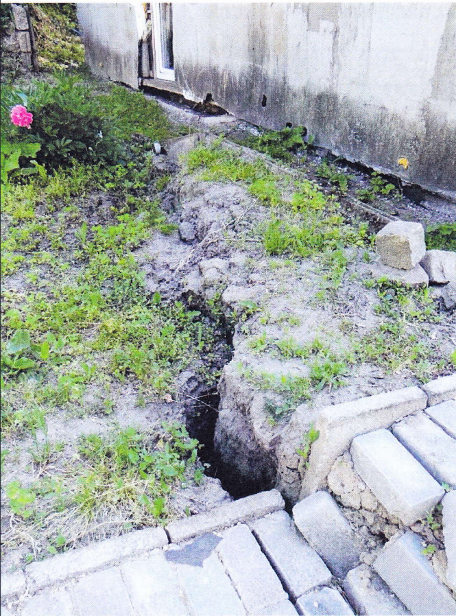
Aktywna część osuwiska - skarpy w okolicy uszkodzonych budynków
